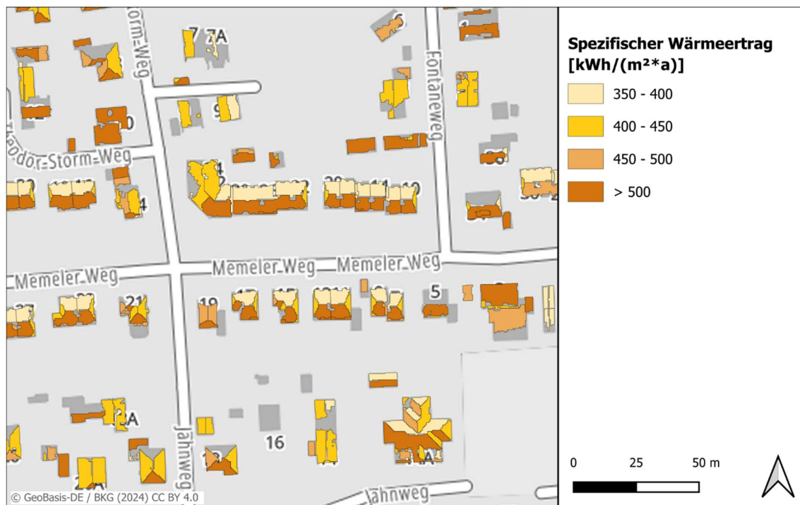
Abbildung 5-3: Spezifischer Wärmeertrag der Potenzialflächen für Solarthermie auf Dachflächen – Detailausschnitt Kernort Adendorf. Quelle: Eigene Darstellung, Datensatz aus Potenzialstudie Landkreis Lüneburg
